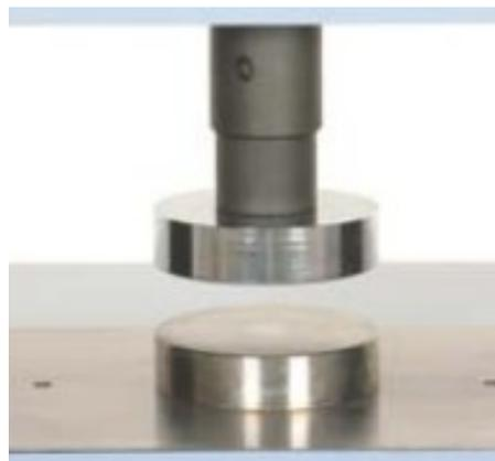
**Figura 12.** Kit de placa de compresión
