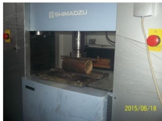
**Figura 14.** Equipo de carga a Compresión Perpendicular a la fibra y módulo de elasticidad en el laboratorio del I.E.I.
