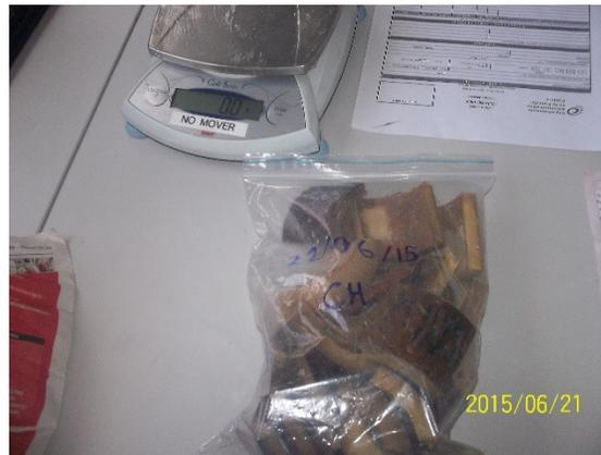
**Figura 15.** Peso de las láminas para determinar el Contenido de Humedad
