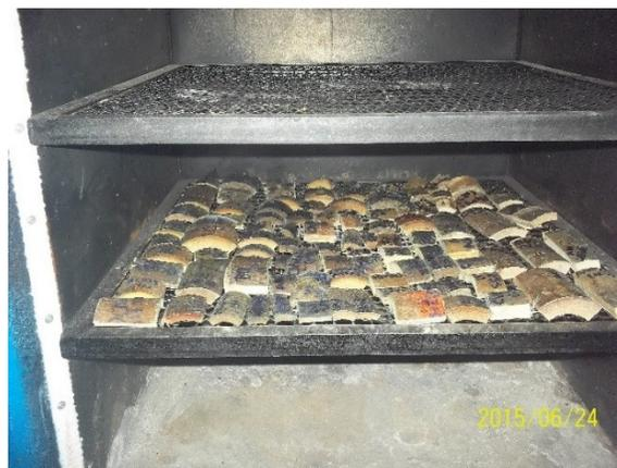
**Figura 16.** Equipo para el proceso de secado de las láminas de guadua en el laboratorio de materiales y cementos del I.E.I.
