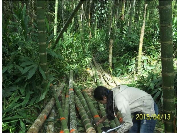
**Figura 8.** Medición de diámetro, espesor y longitud de las 3 secciones longitudinales.
