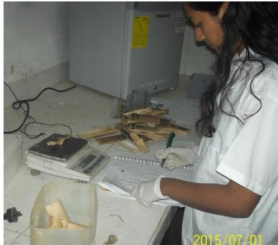
**Figura 17.** Peso de las láminas después de 48 horas de secado en el horno
