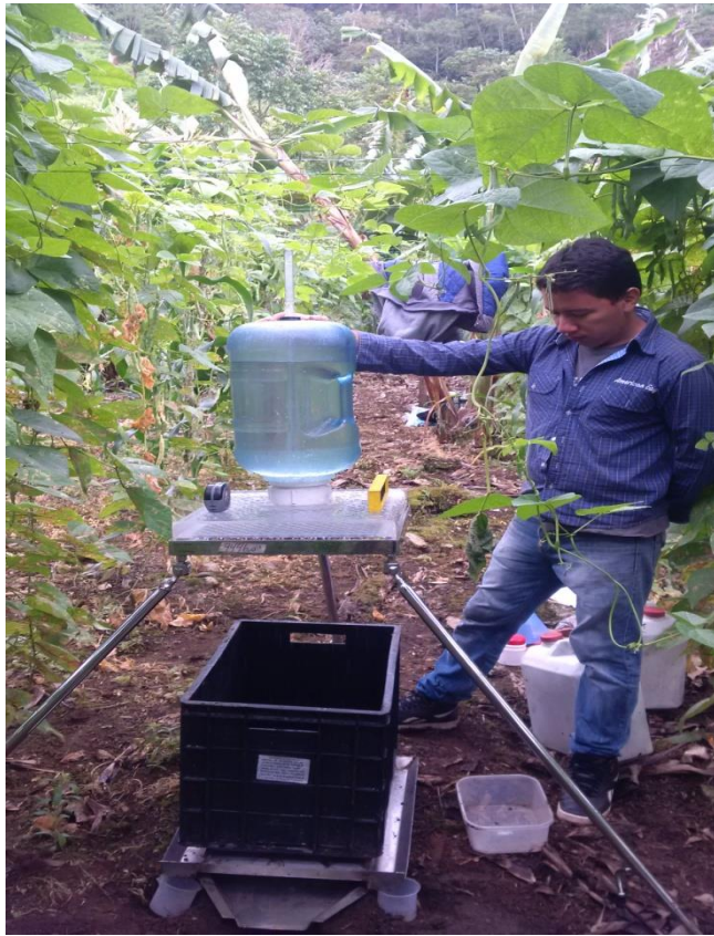
Figura 26. Montaje del mini-simulador de lluvias
