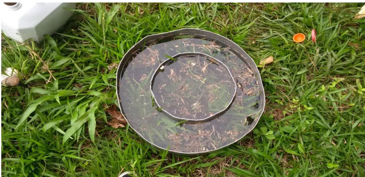
Figura 10. Prueba de infiltración con anillos concéntricos
