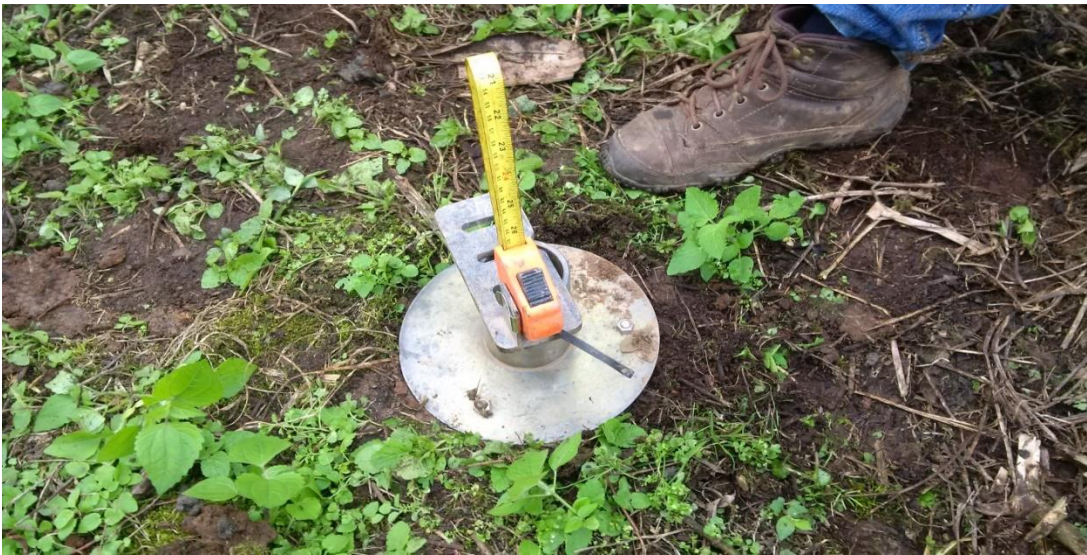
Figura 11. Montaje para prueba de conductividad hidráulica saturada
