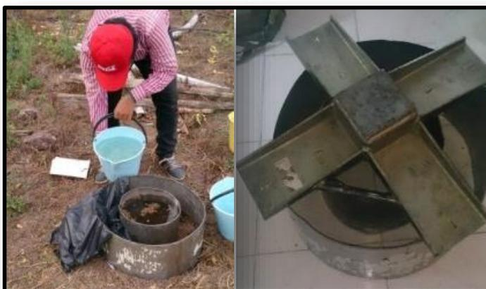
**FIGURA 8: Prueba de Infiltración por el método de Anillos Infiltrómetros**
