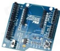
**FIGURA 2. XBEE Shield**
