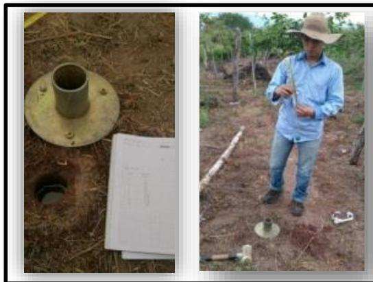
**FIGURA 7: Prueba de auger hole**
