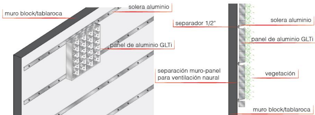
Figura 17. Estructura básica de un panel modular:
