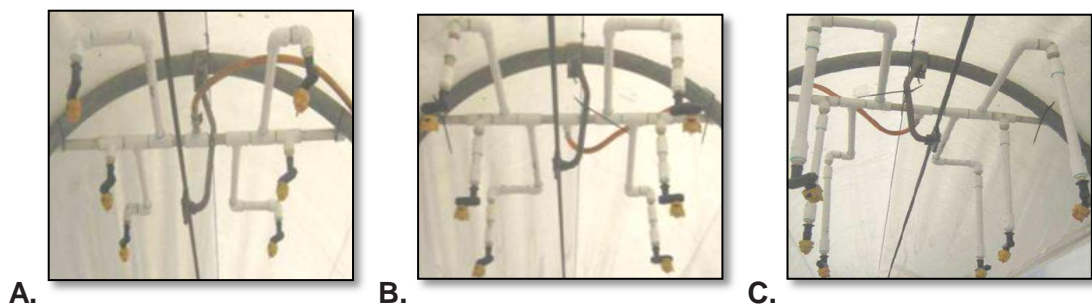
Figura 4. Ubicación de las boquillas e. A; a 30 cm de distancia. B; a 20 cm de distancia. C; a 10 cm de distancia, desde el borde de la malla hasta las boquillas.
