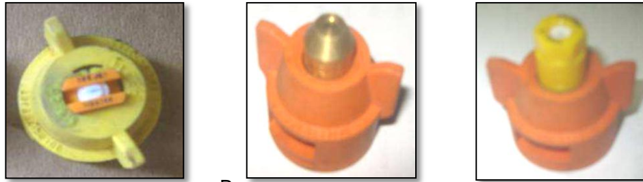
Figura 2. Boquillas de aspersión. A; de cortina (0.68 l/min/boquilla). B; de cono lleno (0.98 l/min/boquilla). C; de con hueco (0.38 l/min/boquilla).
