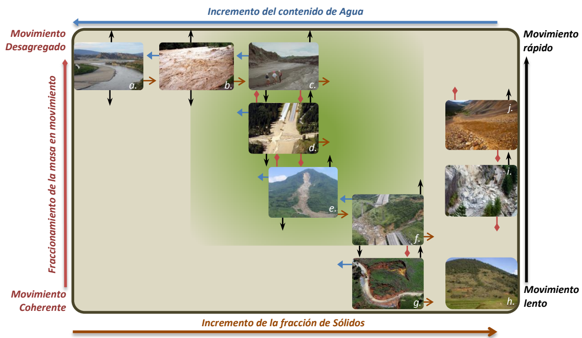
Figura 2. Movimientos en masa observadas en campo y clasificación en función de la fracción de sólidos (→), el contenido de agua (←), la disgregación del material (↕) y la velocidad del movimiento (↑).
