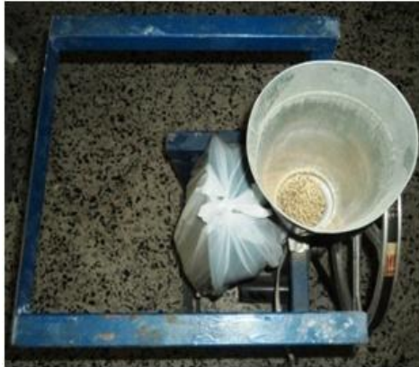
Figura 17: Molino con motor de Potencia 0,5 Hp.
