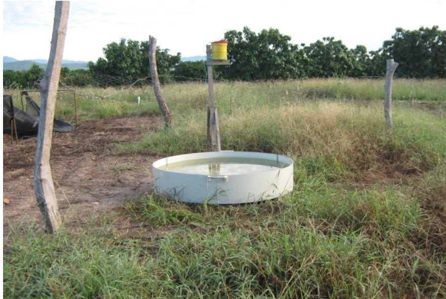
Foto 3. Pluviómetro y tanque evaporímetro clase A
