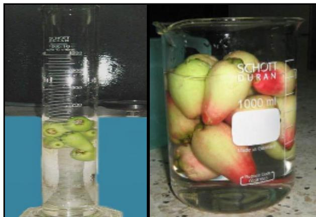
**3.3.1.2 Volumen aparente.** Se determinó colocando los pomarrosos de un peso conocido en una probeta y midiendo el volumen que ocuparon (Ver anexo C).
