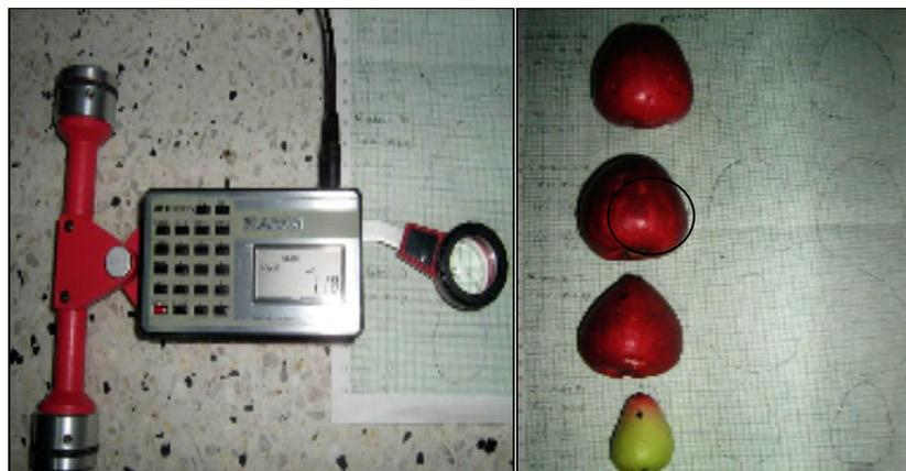
**3.3.1.6 Resistencia a la penetración:** se determinó midiendo la firmeza del fruto, aplicando una fuerza en la sección central de éste, mediante la utilización del dinamómetro marca BERTUZZI 2lb\*.020lbf, (Ver figura 6).
