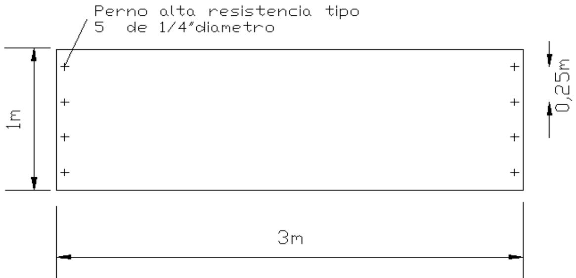
**FIGURA 5. Disposición de tornillos para uniones de la lámina**
