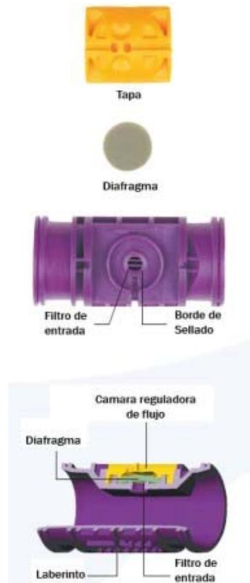
Figura 2 Partes de un gotero Hydro P.C.N.D
