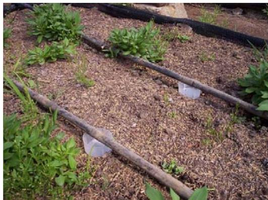
**Figura 16 Aforo de Goteros**
