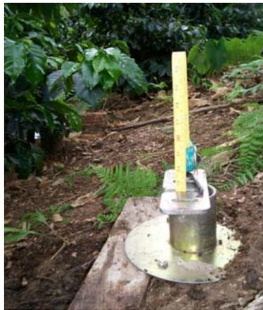
Foto 11. Montaje para prueba de conductividad hidráulica saturada
