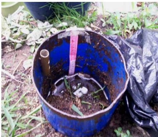
Foto 12. Montaje prueba de infiltración
