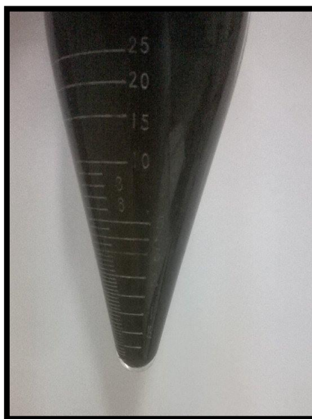
Figura 42: Determinación del % BSW por el método de la centrifuga del Rezumadero AGc
