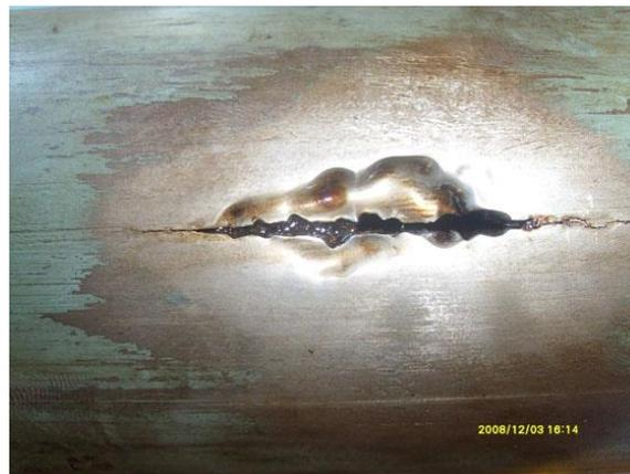
*Figura 11. Barril roto debido a la erosión con arena, fuente: reporte de fallas Occidental de Colombia.*
