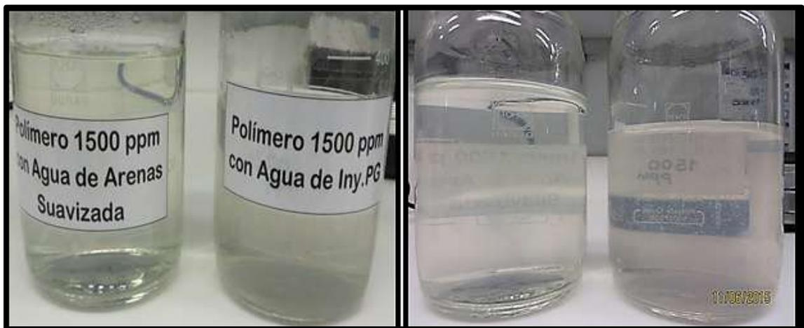
El vaso de precipitado número uno (1) contiene solución polimérica preparada con el agua de inyección de Palogrande y el vaso de precipitado número dos (2) con el agua de Arenas.
