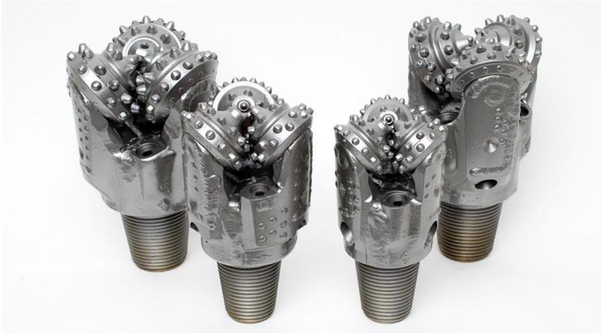
**Figura 3. Tipos de broca utilizadas para perforar un pozo petrolero.**
