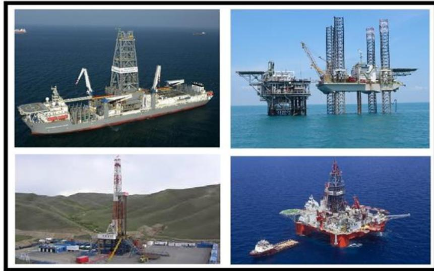
**Figura 4. Diferentes equipos de perforación. Drill ship, Jackup rig, land rig y semisubmersible rig.**
