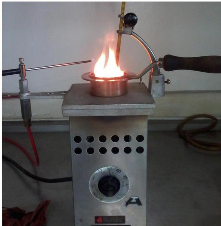
**Fotografía 41.** Determinación del Punto de Chispa y Punto de Inflamación para el crudo del indicio superficial de hidrocarburos del área de la Bocana.
