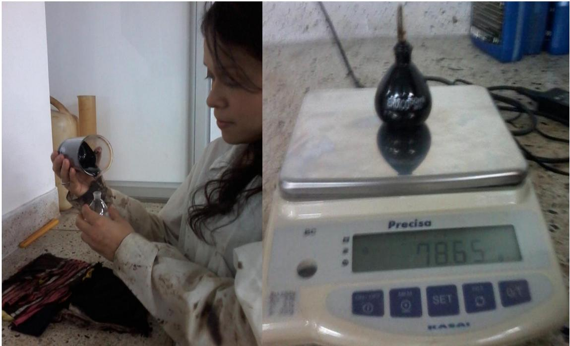
**Fotografía 14.** Determinación de la gravedad API por el método del picnómetro para el crudo del indicio superficial de hidrocarburos del área de La Tribuna.
