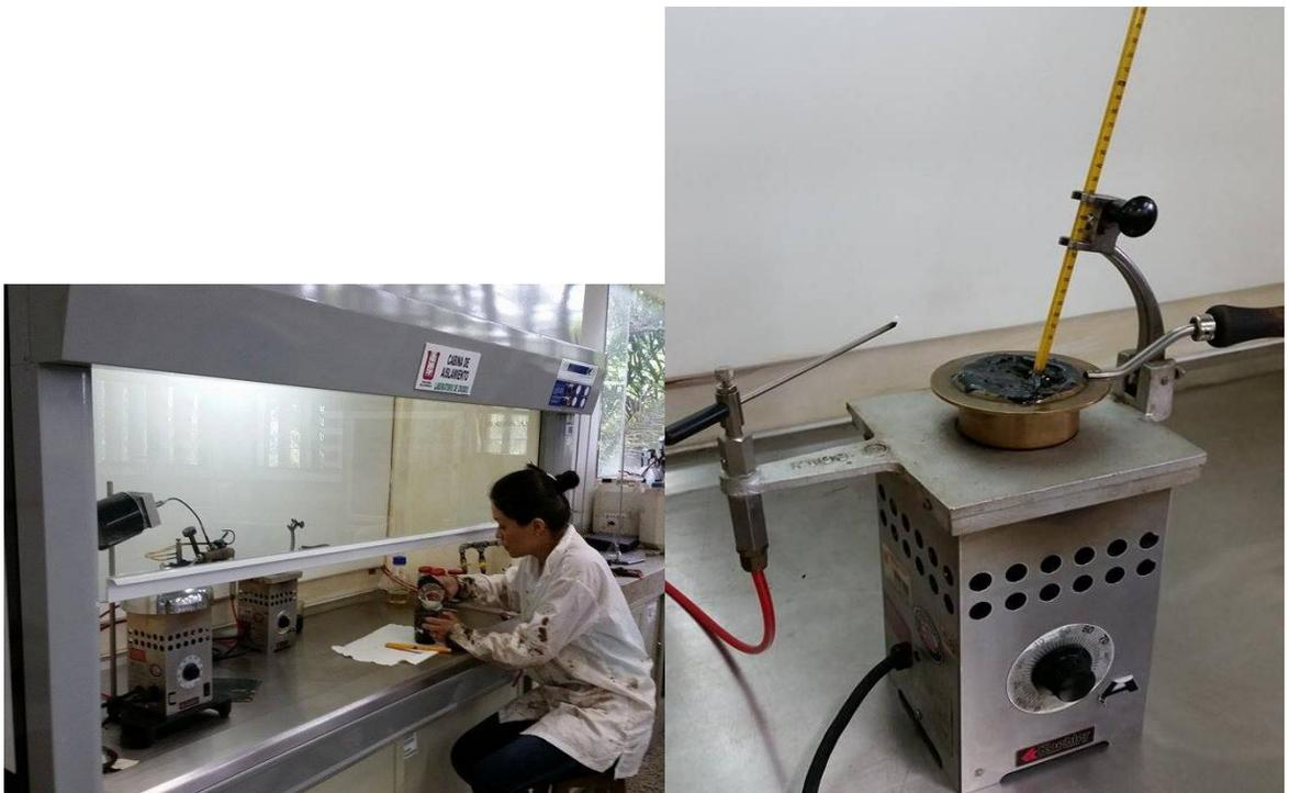
**Fotografía 32.** Determinación del Punto de Chispa y Punto de Inflamación para el crudo del indicio superficial de hidrocarburos del área de la finca México.
