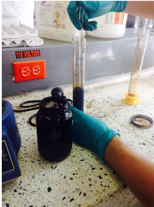
**Fotografía 42.** Determinación del contenido de agua por el método de destilación para el crudo del indicio superficial de hidrocarburos del área de la Bocana.
