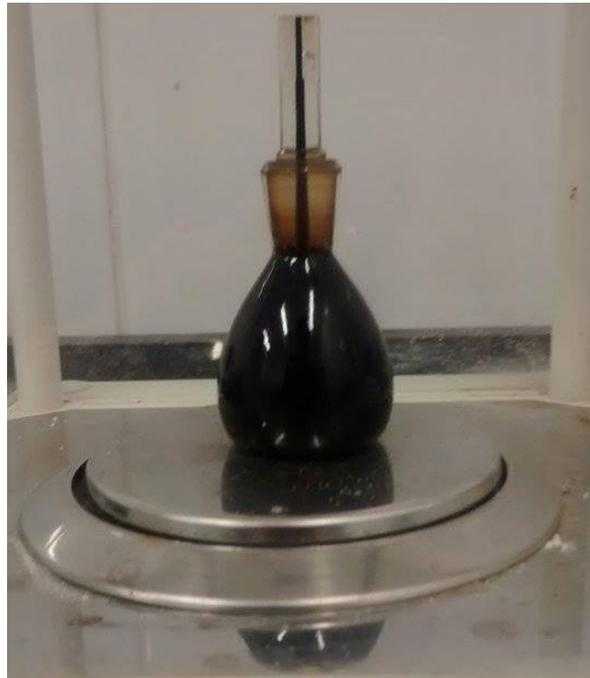
**Fotografía 40.** Determinación de la gravedad API por el método del picnómetro para el crudo del indicio superficial de hidrocarburos del área de la Bocana.
