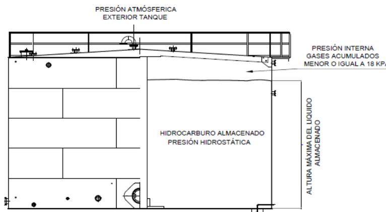
Figura 2.3. Presión interna del tanque de techo cónico.
