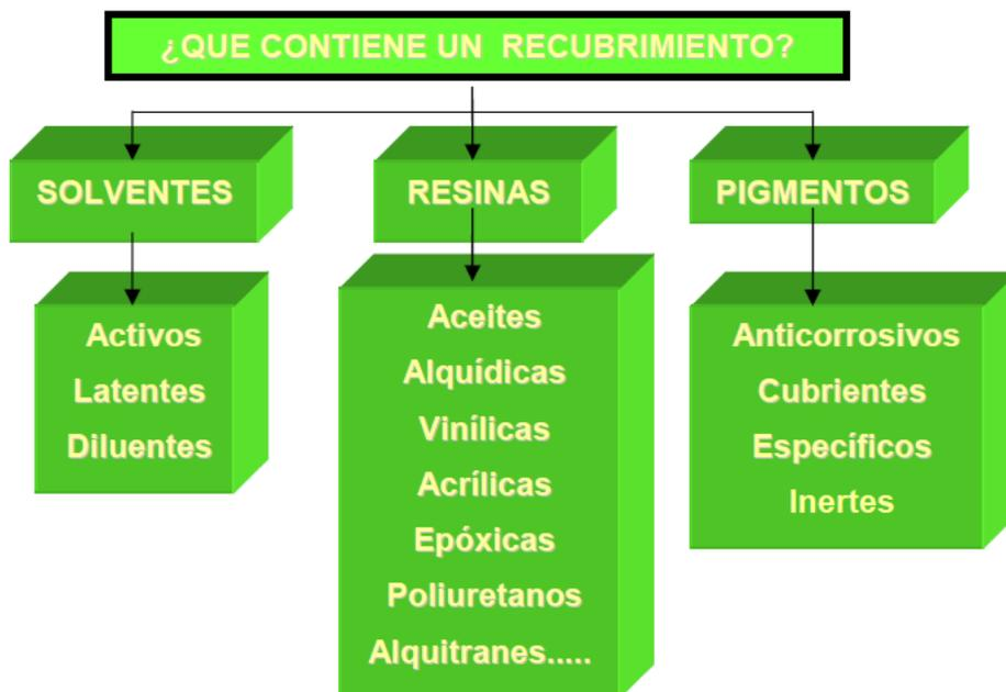
Figura A.28. Descripción de un Recubrimiento de Pintura y Aditivos.
