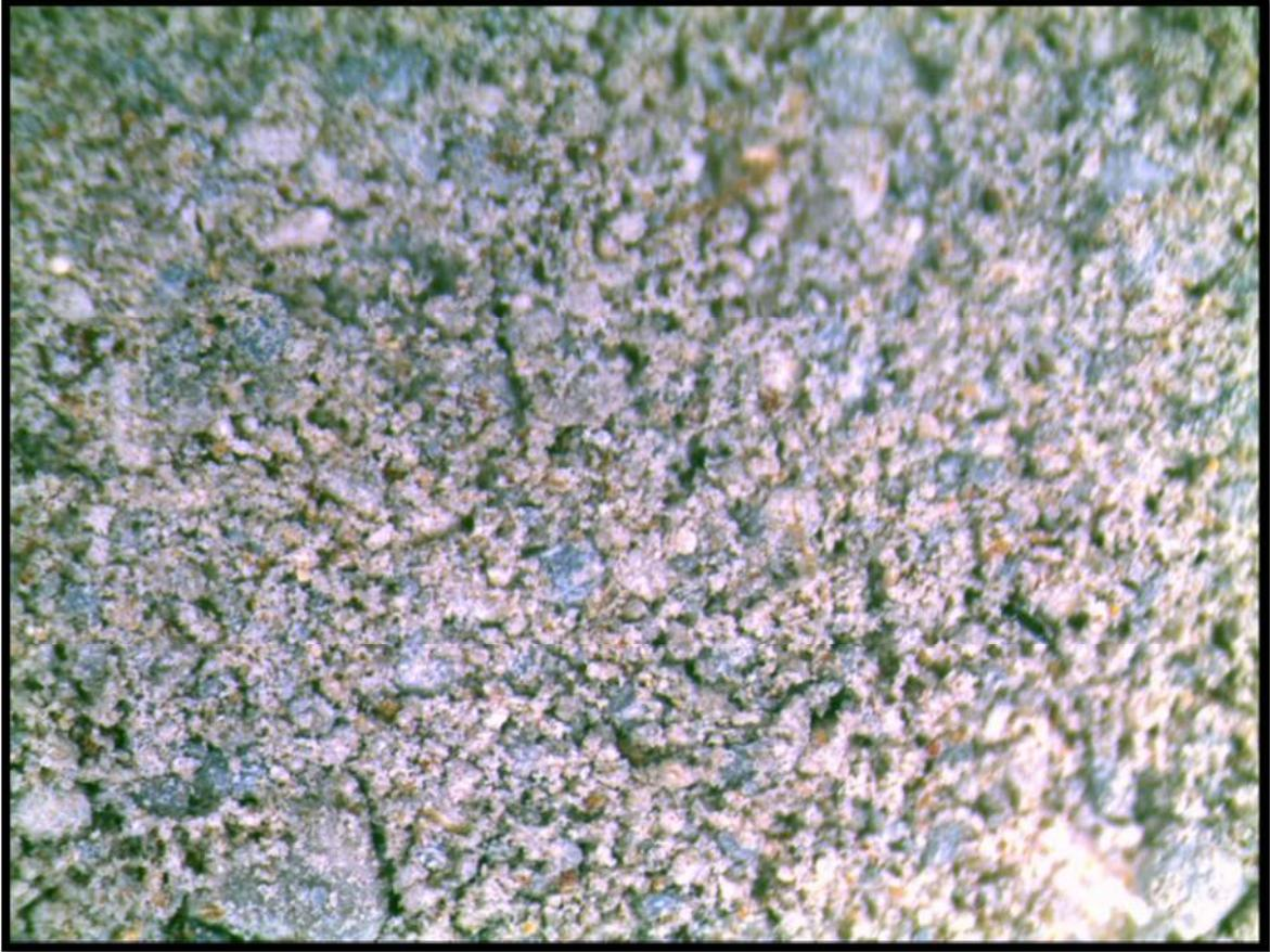
**Fotografía 24. (1 x 10X)** partículas de limo y lodo silíceo recubiertas con una película de arcilla.
