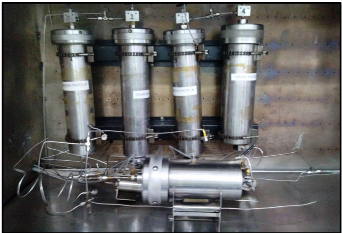
Anexo 16. Core holder y cilindros de desplazamiento.
