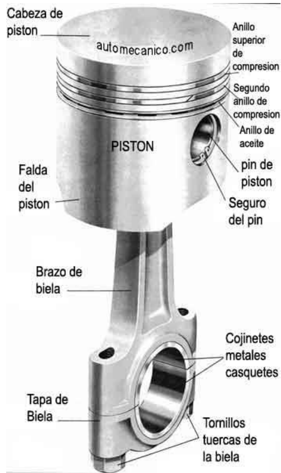
Fig. 2.3.3 A Partes del Pistón
