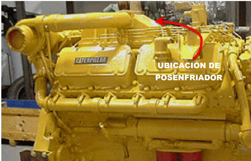
Fig. 2.1.3 Ubicación del Pos-enfriador
