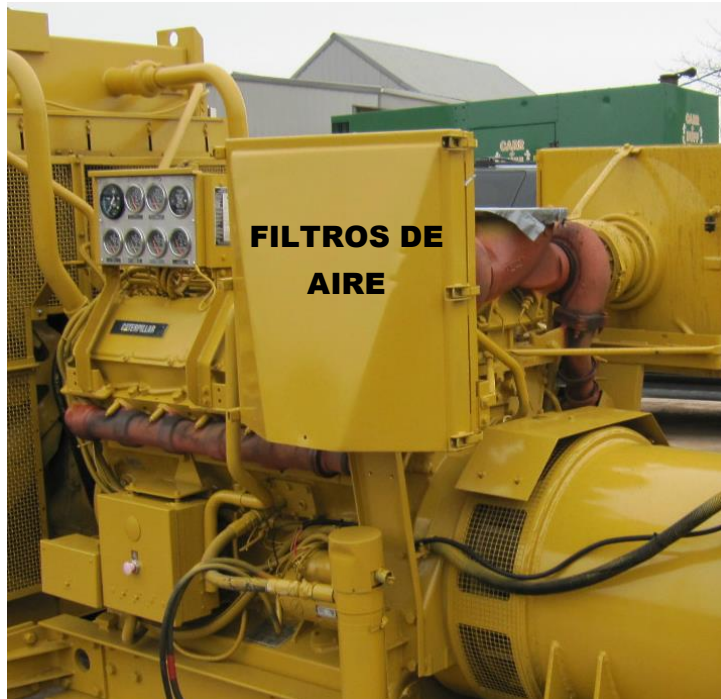
Fig. 2.1.1 Ubicación de los Filtros de Aire
