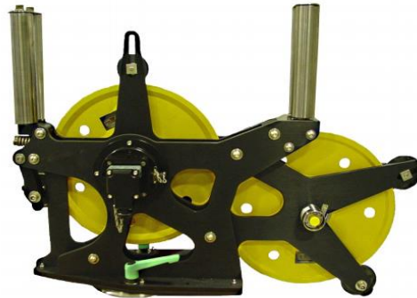
Figura 21. Dispositivo de medición de Wireline
