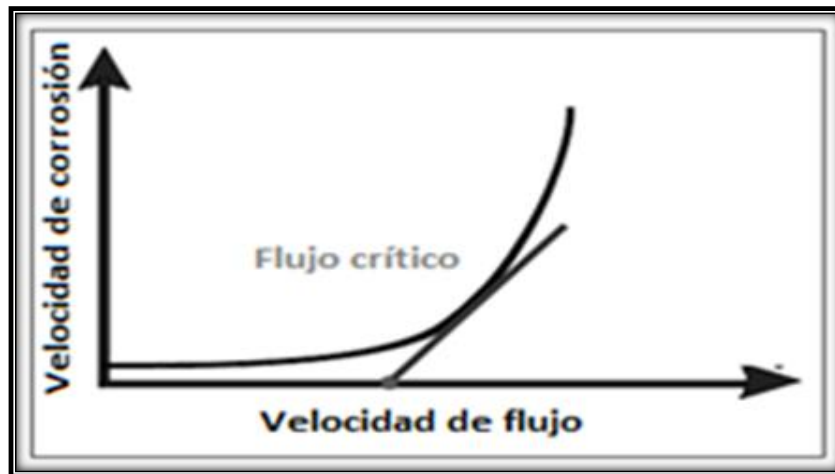
Figura 19 Efecto del flujo sobre la velocidad de la corrosión
