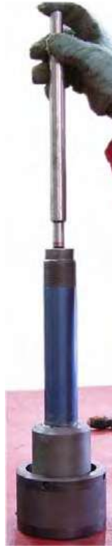
Figura 58 - Instalación de tubo de flujo dentro de primera sección.
