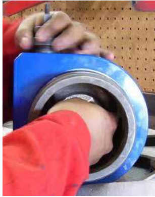
Figura 18 - Forma de roscar la tapa dentro del eje.
