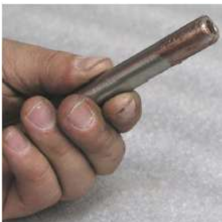
Figura 38 - Instalación de brass O-ring y Back-up ring de 8-206 V75.
