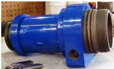
Figura 15 - Lubricación después de instalación de O-rings en sub ensamble de fondo.
