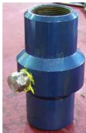
Figura 63 - Instalación de tapón.
