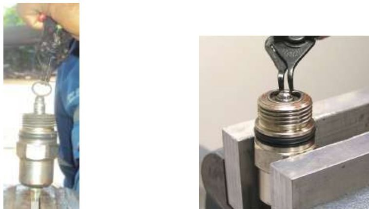
Figura 35 - Instalación del Snap Ring por encima de la washer.
