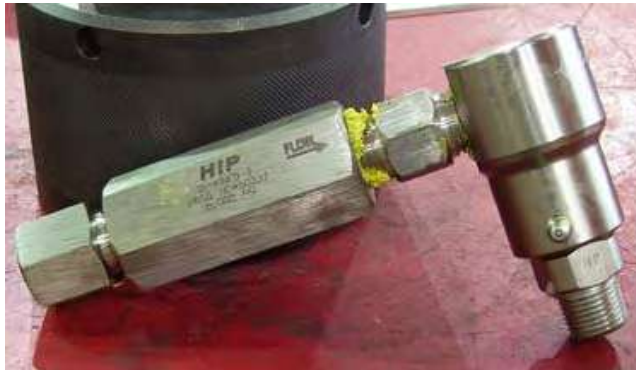
Figura 60 - Instalación de válvula check.
