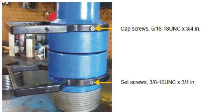
Figura 21 - Instalación de guarda manija.
