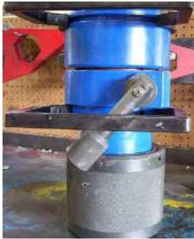
Figura 24 - Manija en posición de 1. “atrapar” y en posición 2. “soltar”.
