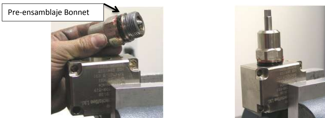
Figura 46 - Instalación O-ring 2-205 V75 de Pre-ensamblaje Bonnet en la válvula.
