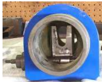
Figura 17 - Instalación del eje a través del flapper.
