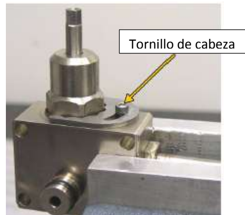
Figura 42 - Lubricación de tornillo e instalación de éste en el retenedor Bonnet.
