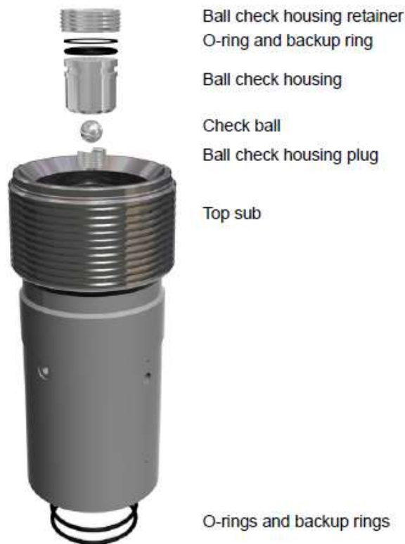
Figura 52 - Sub ensamblaje del tope, bola de retención en el housing e instalación de sellos.
