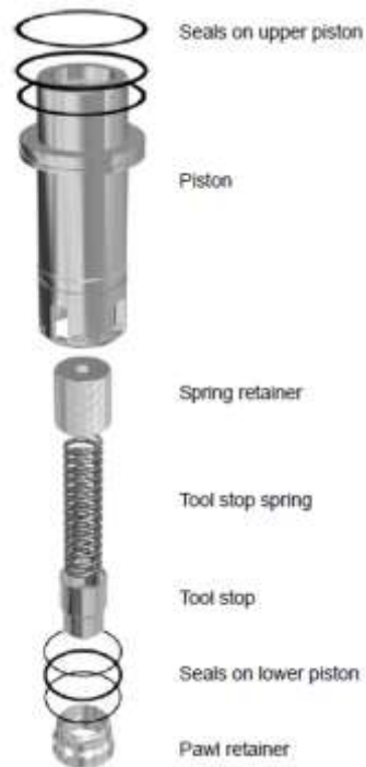
Figura 51 - Instalación de O-rings y Back-up rings en el cuerpo del pistón.
