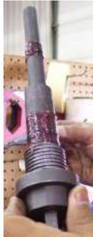
Figura 16 - Instalación del eje dentro de la tapa.
