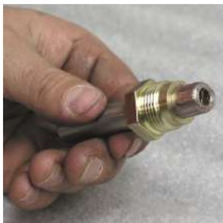
Figura 38 - Instalación de brass O-ring y Back-up ring de 8-206 V75.
