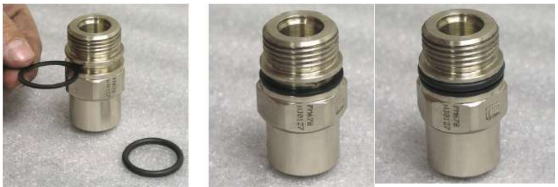
Figura 29 - Instalación O-Ring 2-214 V75 y Back up Ring 8-214 V75.
