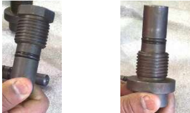
Figura 12 - Instalación de O-ring 2-210 V75 y Back-up ring 8-210 V90.
