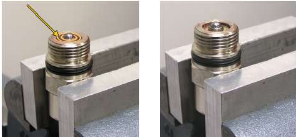
Figura 34 a y b - Instalación de sellos polyPak y retenedor Brass PolyPak.
