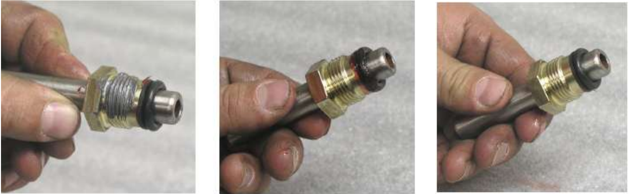
Figura 39 - Instalación de O-ring 2-206 V75 y aplicación de grasa.
