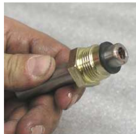
Figura 38 - Instalación de brass O-ring y Back-up ring de 8-206 V75.
