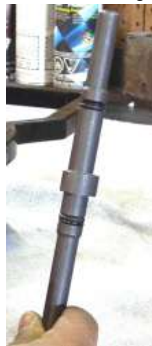
Figura 13 - Instalación de O-rings 2-204 V75 y Back-Orings 8-204 V90.
