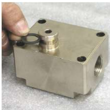
Figura 37 - Instalación de back-up ring de 8-206 V75D y O-ring 2-206 V75D.
