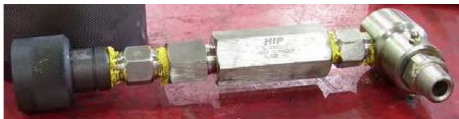
Figura 61 - Instalación de boquilla y coupling macho con tuerca de bloqueo.
