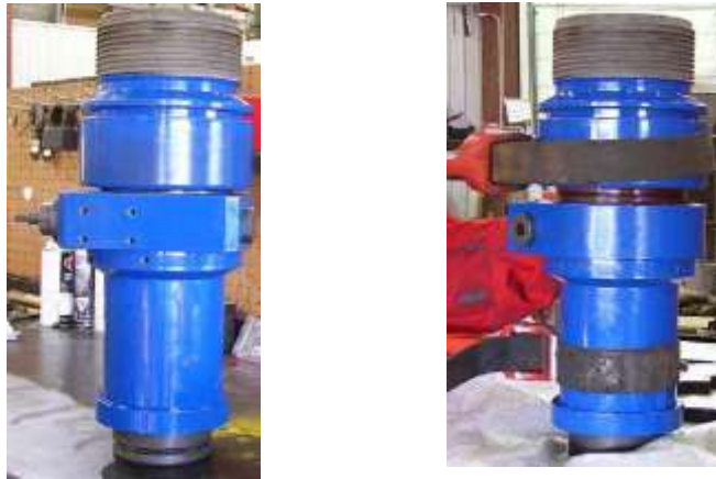
Figura 20 - Unión de los ensambles de subs tope y fondo.
