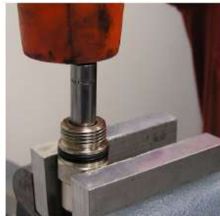
Figura 33 - Instalación de retenedor Brass polyPak.
