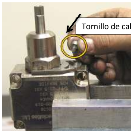
Figura 48 - Ajuste de tornillo de cabeza para retenedor Bonnet.
