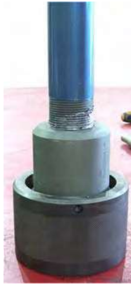
Figura 57 - Instalación de primera sección del mango.
