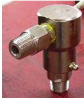
Figura 59 - Instalación de boquilla dentro de torniquete.
