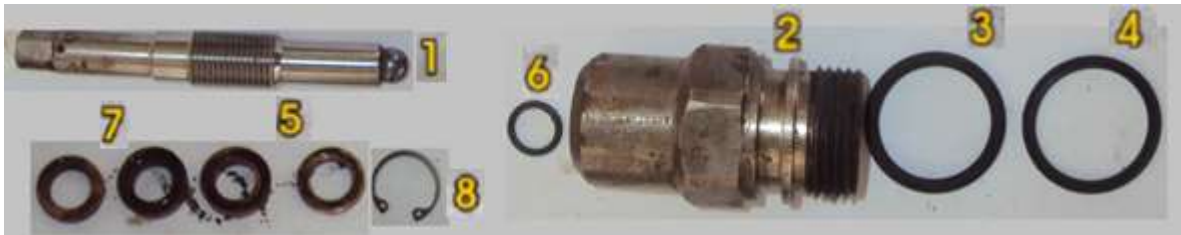
Figura 26 - Ensamblaje Bonnet desarmado usado.
