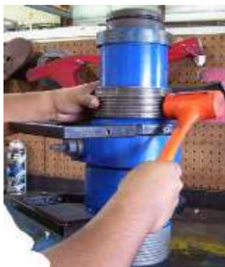
Figura 22 - Aseguración de la unión de los subs ensamblés.
