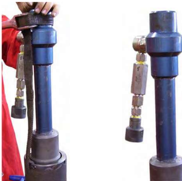
Figura 62 - Instalación de ensamble de llenado y adaptador con el mango.
