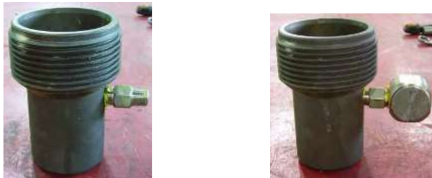
Figura 64 - Instalación de boquilla e instalación de codo.
