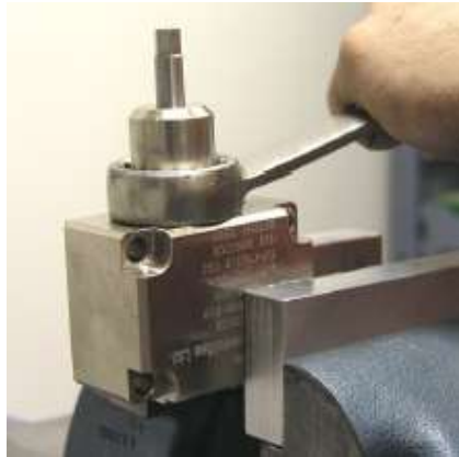
Figura 47 - Instalación de retenedor Bonnet.
