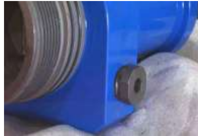
Figura 19 - Instalación de tapa terminal dentro del eje.
