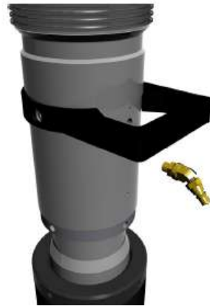
Figura 54 - Instalación de adaptador ligero.
