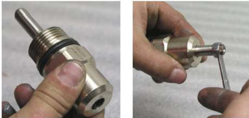
Figura 31 - Instalación del vástago dentro el cuerpo de la válvula.
