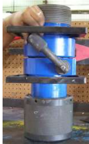
Figura 24 - Manija en posición de 1. “atrapar” y en posición 2. “soltar”.
