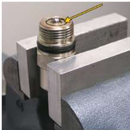
Figura 33 - Instalación de retenedor Brass polyPak.
