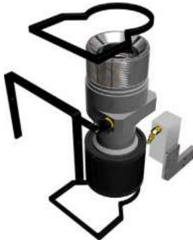
Figura 11 - Instalación de guardas a la tool trap.
