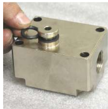
Figura 37 - Instalación de back-up ring de 8-206 V75D y O-ring 2-206 V75D.
