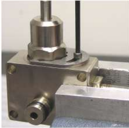
Figura 43 - Ajuste de tornillo con llave, válvula con ensamblaje completo (final).
