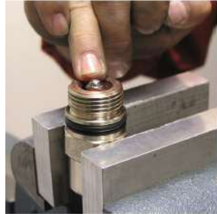
Figura 32 - Aplicación de grasa sobre vástago de la válvula.
