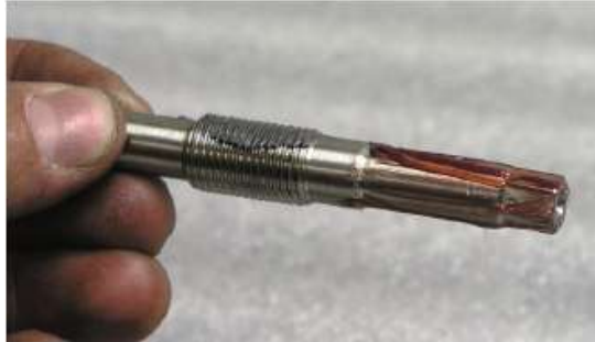
Figura 30 - Lubricación del vástago de válvula.
