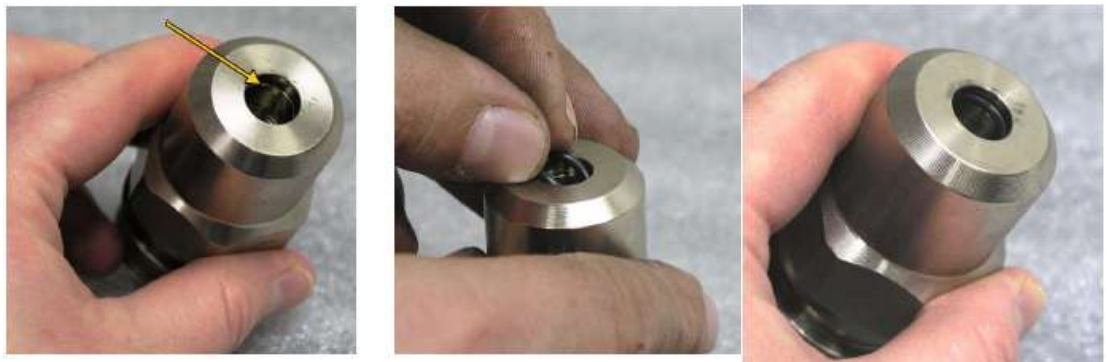
Figura 28 - Instalación O-ring interno 2-012 V75.
