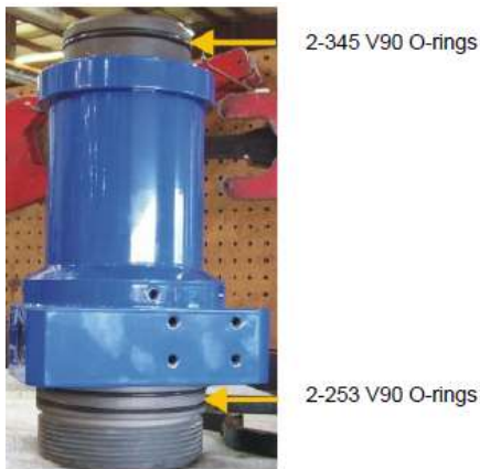
Figura 14 - Instalación de O-rings 2-253 V90 y 2-345 V90 en OD externo del sub-fondo y ensamble.
