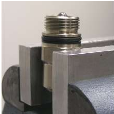
Figura 32 - Aplicación de grasa sobre vástago de la válvula.
