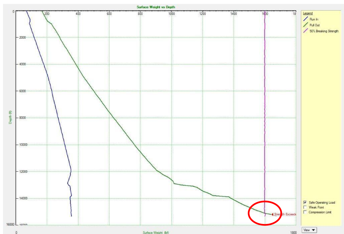
Figura 25. Registro de tensiones para asentar un tapón en el pozo USCO-2, con la Unidad LAT
