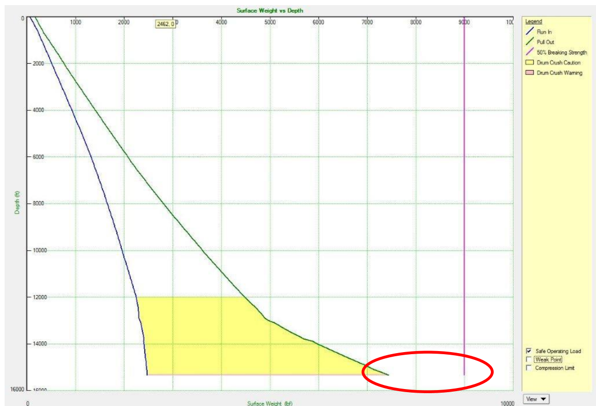
Figura 26. Registro de tensiones para asentar un tapón en el pozo USCO-2 con la Unidad E-line
