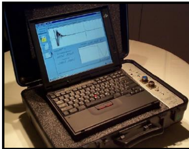
Ilustración 4: Computador acoplado al analizador de pozos Fuente: Manual TWM Echometer Company
