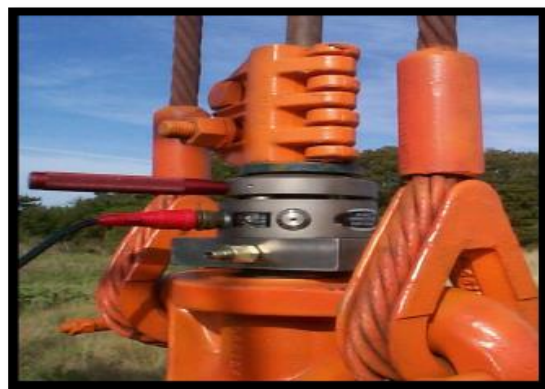
Ilustración 11: Celda tipo Herradura con elevación de carga. Fuente: Manual TWM Echometer Company
