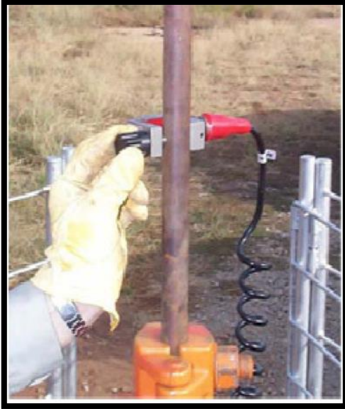
Ilustración 9: Instalación de transductor en la barra pulida. Fuente: Manual TWM Echometer Company
