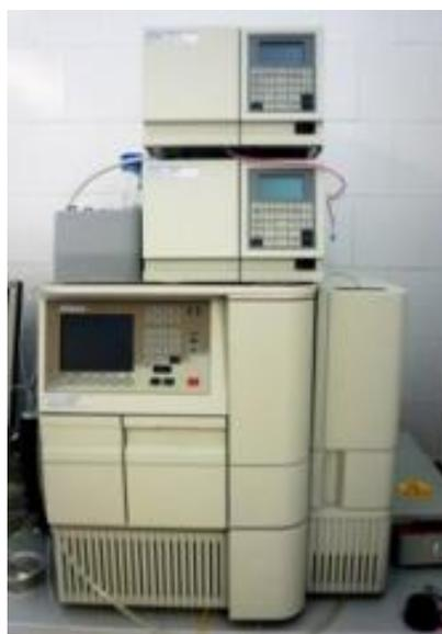
Figura 17: Cromatógrafo HPLC.
