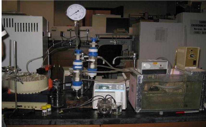
Figura 15: Equipo usado para realizar la prueba de columna.
