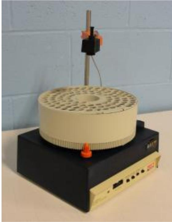
Figura 16: Recolector de muestras LKB Bromma.
