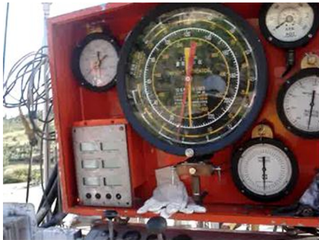
Imagen 18. Consola del perforador
