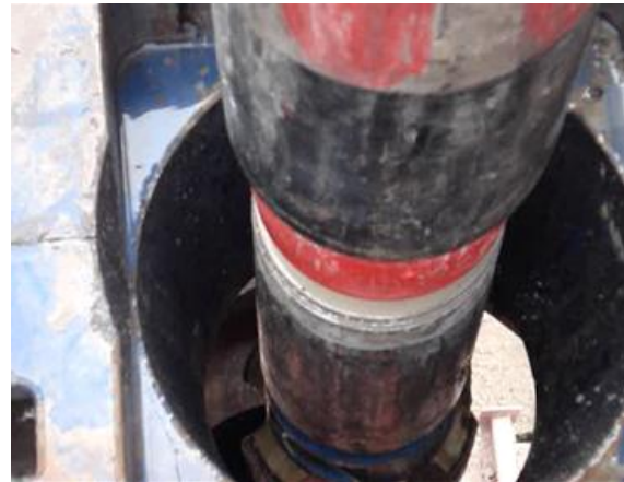
Imagen 7. Bajando al pozo broca y herramientas direccionales
