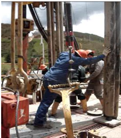
Imagen 8. Sacando tubería a superficie
