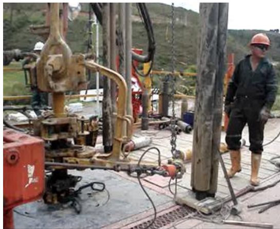
Imagen 4. Viaje de tubería a superficie
