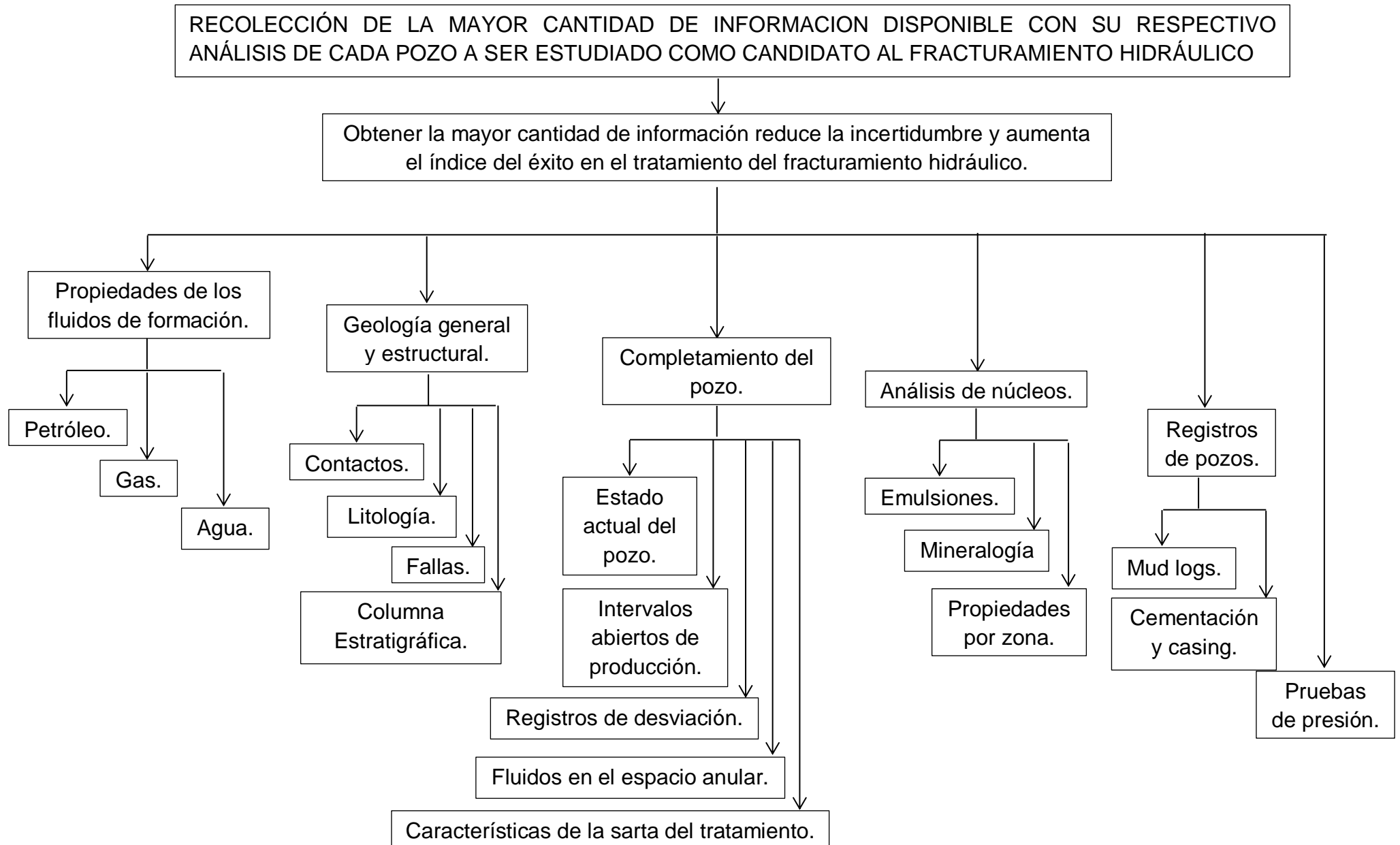
Figura 2.2 Diagrama de Información requerida de un pozo para la selección de candidatos
