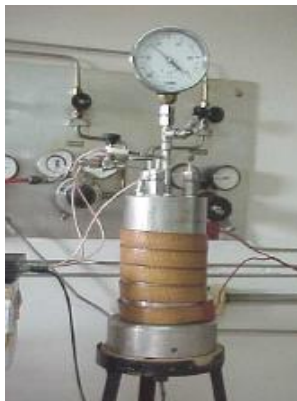
Figura 4. Autoclave estática para la prueba de velocidad de corrosión general.
