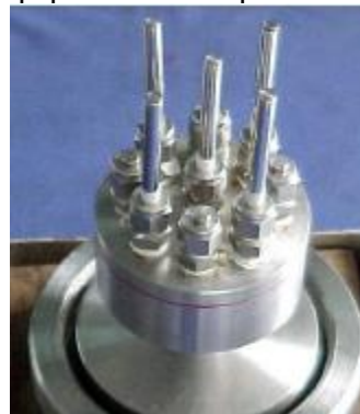
Figura 5. Tapa de la autoclave con arreglo de múltiples electrodos.
