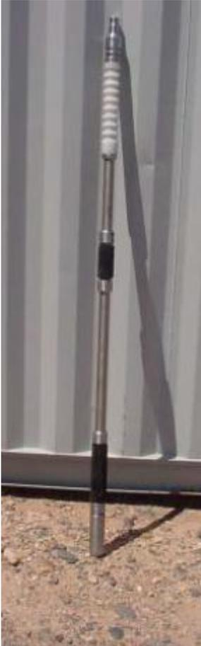
Se utiliza para aplicaciones de Gas Lift asistido con un plunger, donde pistones de poca longitud puedan estrellarse en los cambios de diámetro especialmente en los mandriles y no puedan alcanzar un desplazamiento completo
