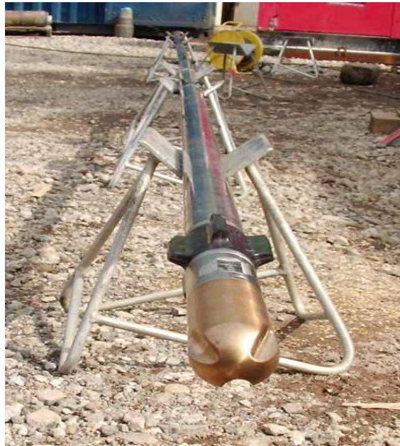
Figura 18. Herramienta MWD en superficie
