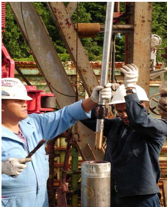
Figura 19. Herramienta MWD al momento de introducirse en el collar no magnético durante una bajada de tubería al pozo
