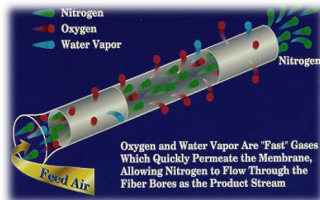
Figura 9: Tecnología de membrana para producción de nitrógeno.
