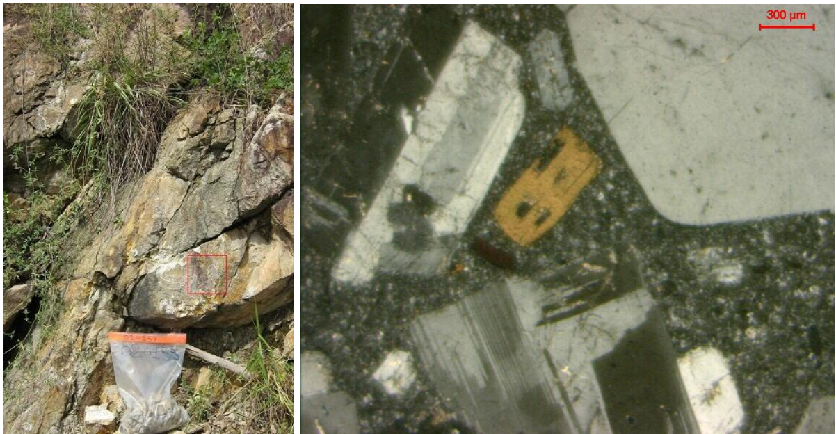
Figura 25. Fotografía afloramiento de dacitas porfiríticas donde se tomo la muestra PJ 210 (izquierda). Fotografía microscópica fenocristales de plagioclasa (Pg), cuarzo (Qz) biotita (Bi) en matriz dacítica muestra PJ 210. (derecha)
