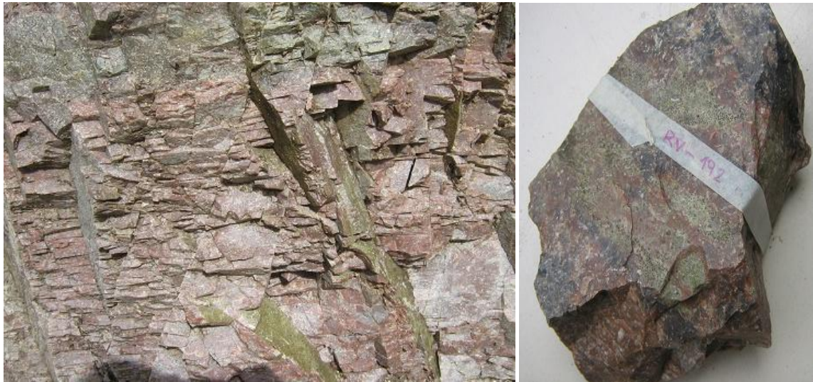
Figura 34. Fotografía afloramiento muestra PJ-192 mostrando procesos de silificación. Reemplazando las rocas piroclásticas en jaspe.
