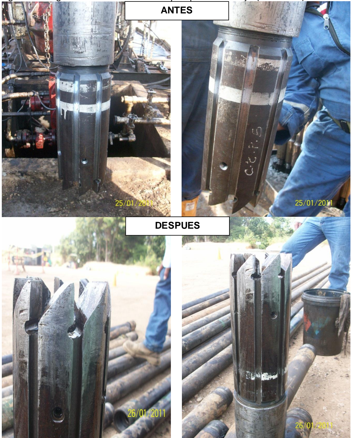
Figura 37. Imagen de la Corona de 5" antes y después del trabajo. (Restricción)
