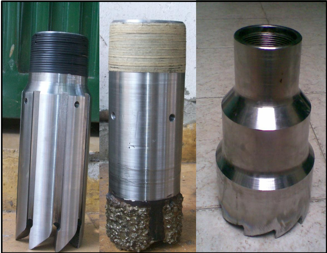
Figura 25. Esquema de Coronas de 5", 4 ½ " y 7 ¾ ".
