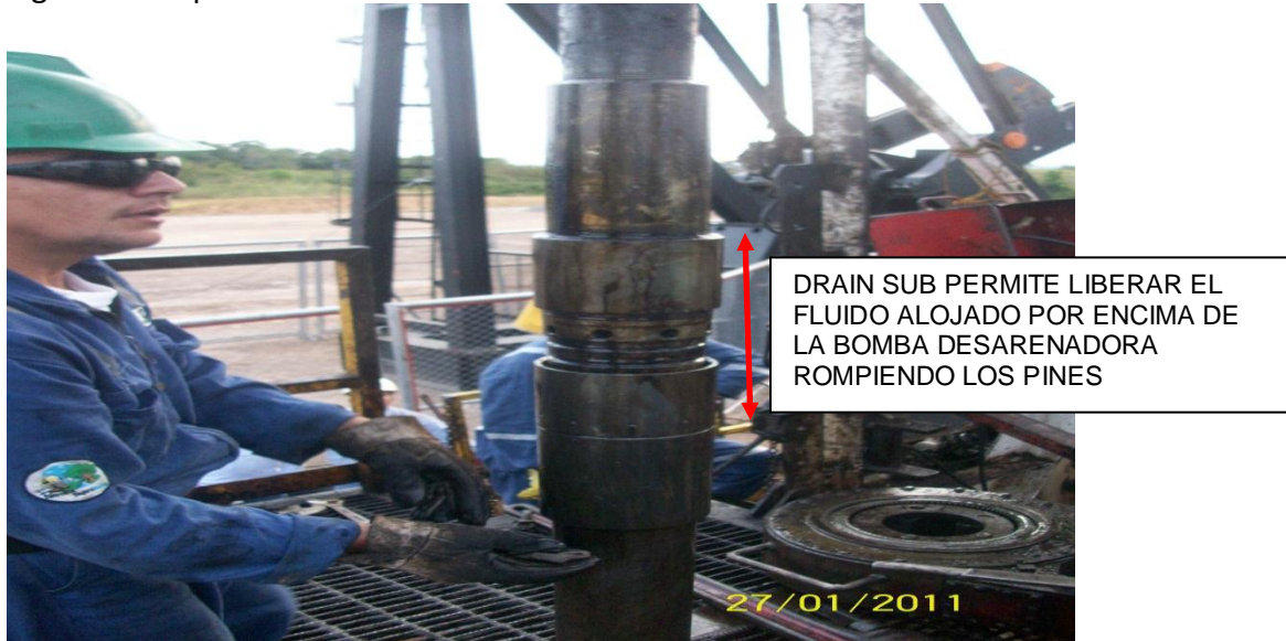
Figura 38. Representación de la Drain Sub.
