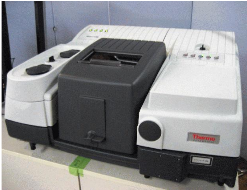
Figura 8. Equipo de Espectroscopia de Gases, Espectroscopio Nicolet FT-IR 6700.
