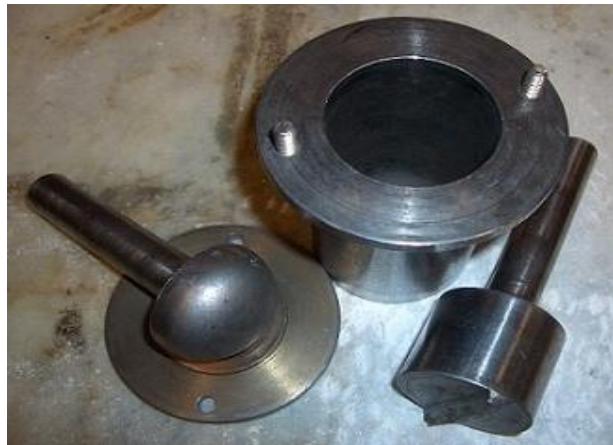
Figura 2. Cilindro para la trituración de la muestra de Shale. vii
