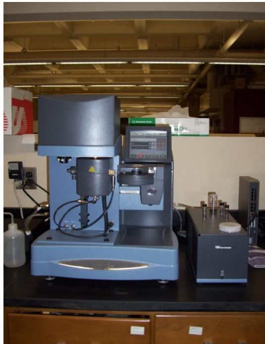
Figura 9. Equipo de Análisis Termogravimétrico, TGA Q5000, Thermo Instruments.
