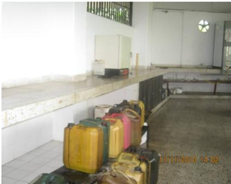
Figura 8. Depósitos para disposición de fluidos residuales
