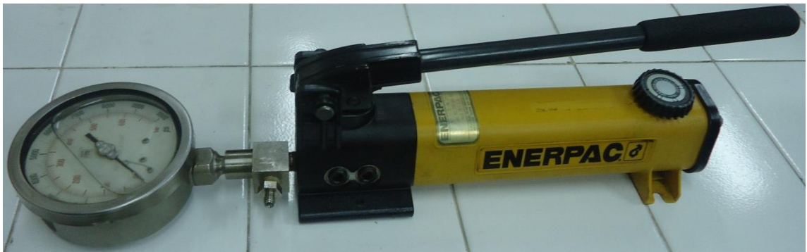
Fig.11. Bomba de desplazamiento positivo.
