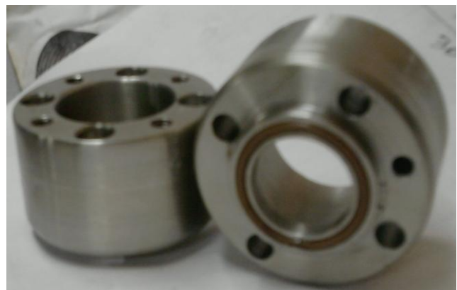
Fig.15. Ventanas, orings y piezas para soporte de los sensores infrarrojos NIR
