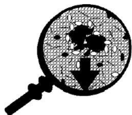
Figura 20. Migración de resinas de la superficie de los asfaltenos debido a la diferencia del potencial químico.
