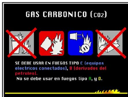
FIGURA 35. Extintor de Dióxido de Carbono
