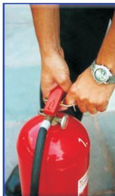
**Figura 3. Paso 2 para uso del extintor.**
