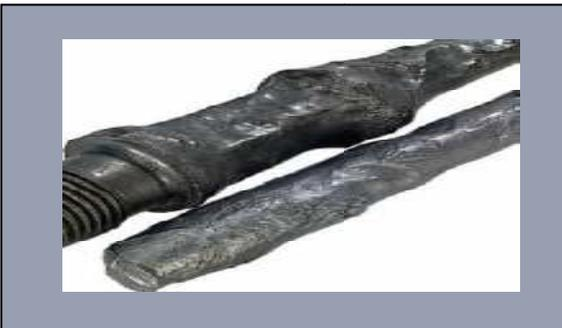
Figura 12. Corrosión por O<sub>2</sub>
