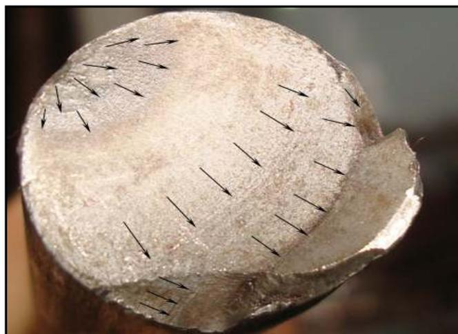
Figura 23. Zona de propagación de la falla
