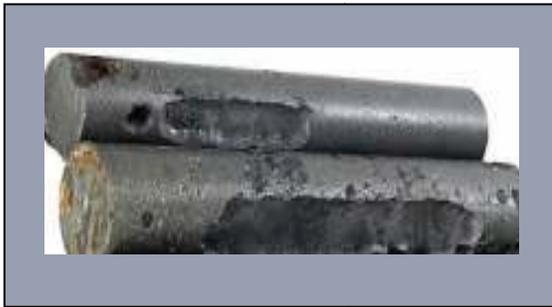
Figura 10. Corrosión por CO<sub>2</sub>
