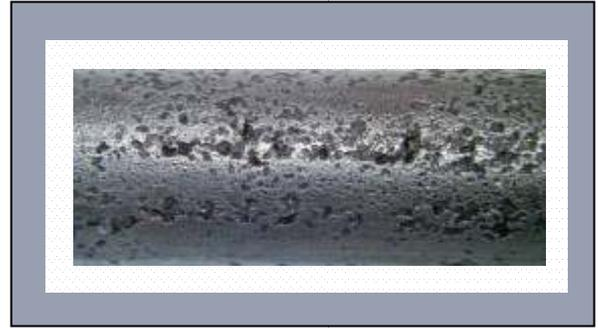
Figura 9. Corrosión por cloruros
