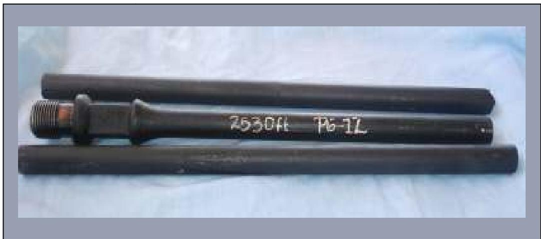
Figura 20. Muestras recibidas para análisis, correspondiente a tres secciones de varilla del pozo PG-12
