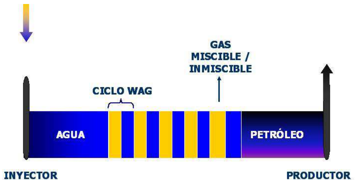
Figura 1. Esquema del proceso WAG.
