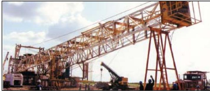
**FIGURA 7.** Levantamiento del Mástil.
