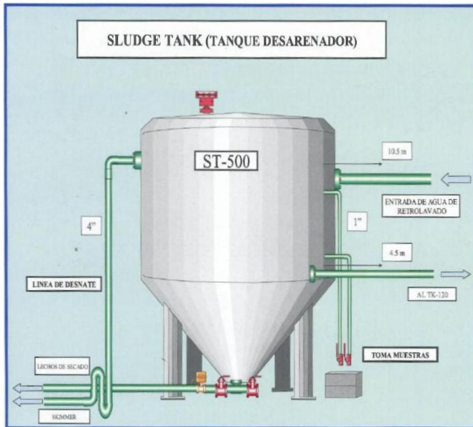
Figura 2.18. Cambios Propuestos para Sludge Tank
