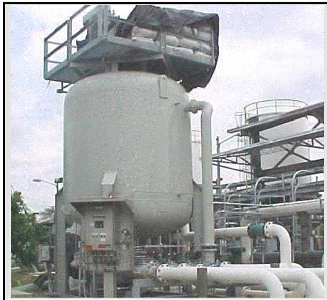
Figura 2.10 Filtro Cascara de Nuez en Funcionamiento
