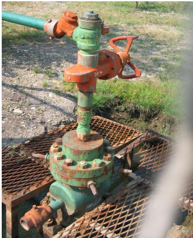
*Figura 3.1. Modelo Cabezal Actual Pozos Inyectores*
