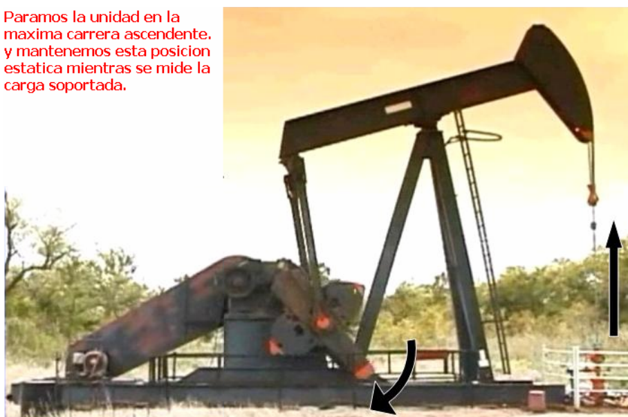
Figura 23. Posición de la unidad para verificación de la válvula viajera
