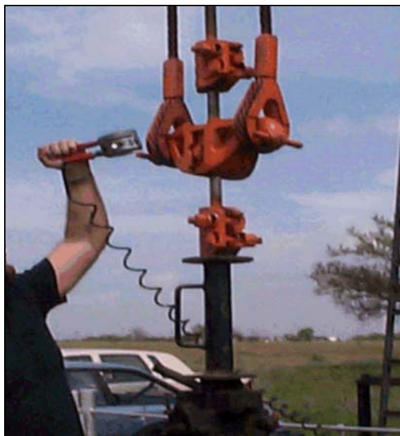
Figura 22. Colocación de la celda
