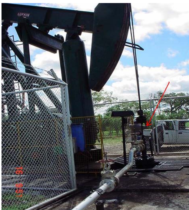
Figura 21. Unidad preparada para la toma de Dinagramas
