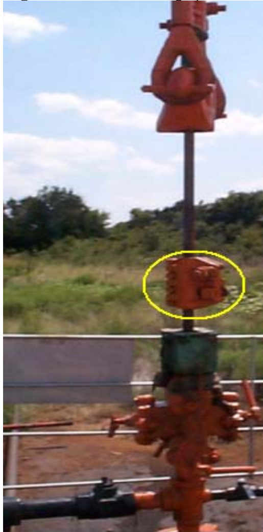
Figura 20. Posición de la grapa auxiliar
