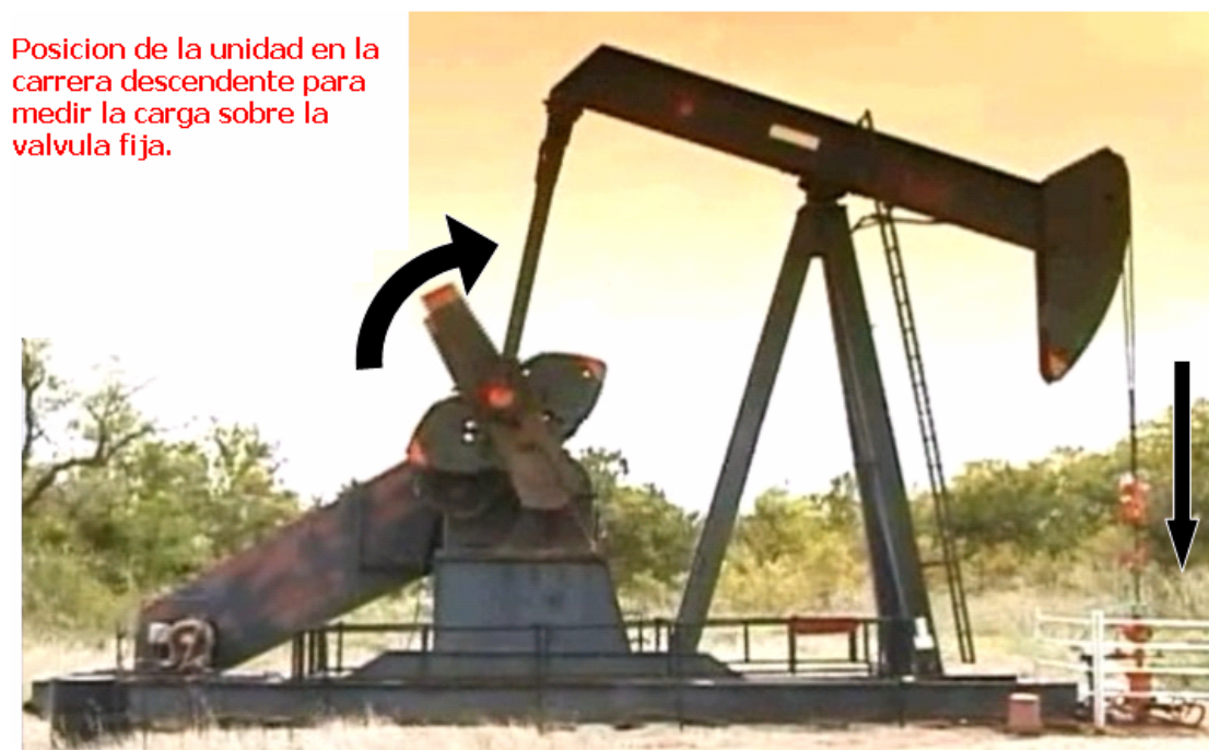
Figura 26. Posición de la unidad para verificación de la válvula fija
