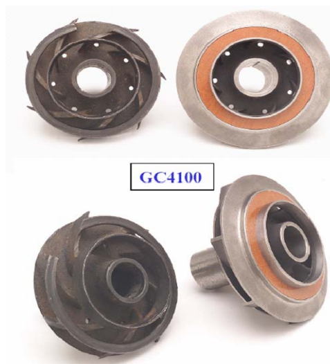
Figura 73. Desgaste de empuje axial ascendente o descendente en las superficies de roce de la etapa.
