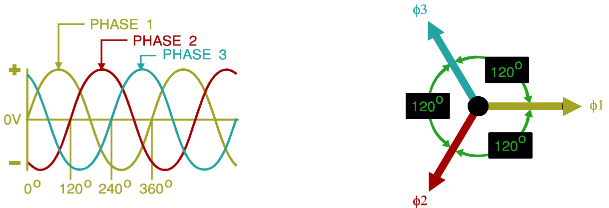
Figura 7. Corriente alterna de tres fases.
