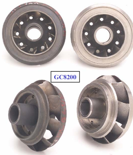
Figura 74. Desgaste erosivo en la zona del paso de fluido en las etapas debido a la alta velocidad y abrasividad de la arena.
