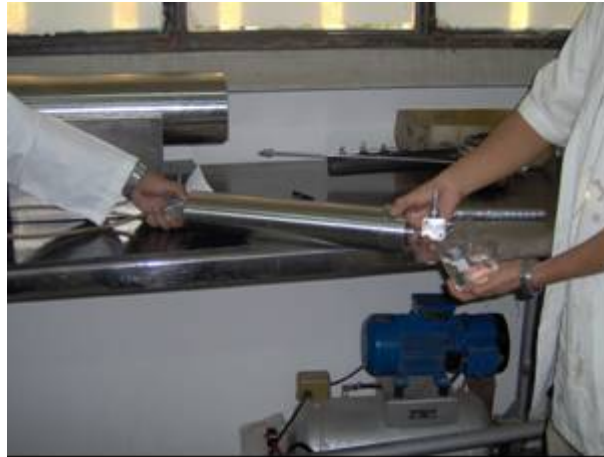
Figura 21. Limpieza cilindros de inyección
