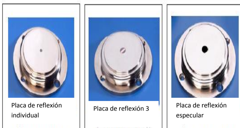
Figura No 9: Placas Universal. Fuente: Manual del usuario ATR
