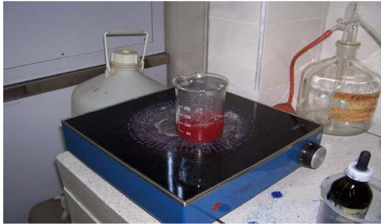
**FOTO 5. MONTAJE PARA DETERMINAR HUMEDAD EN LAS MUESTRAS**
